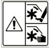
Outils rotatifs : risque de sectionnement de membres
