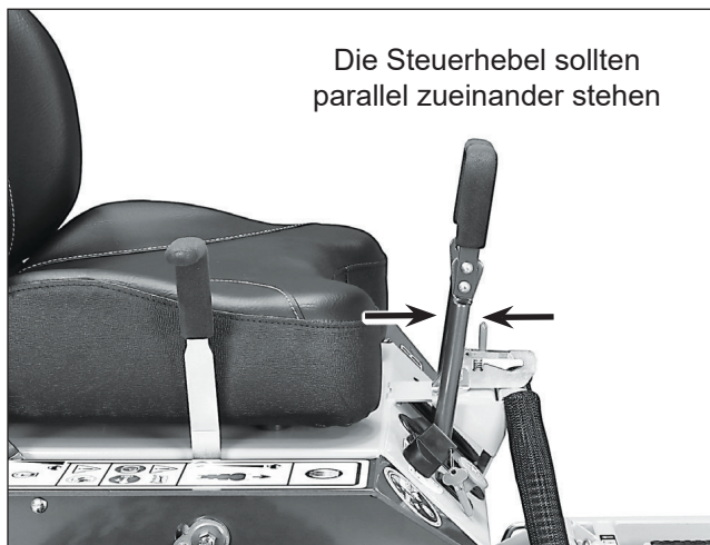
Steuerhebel Einstellung
