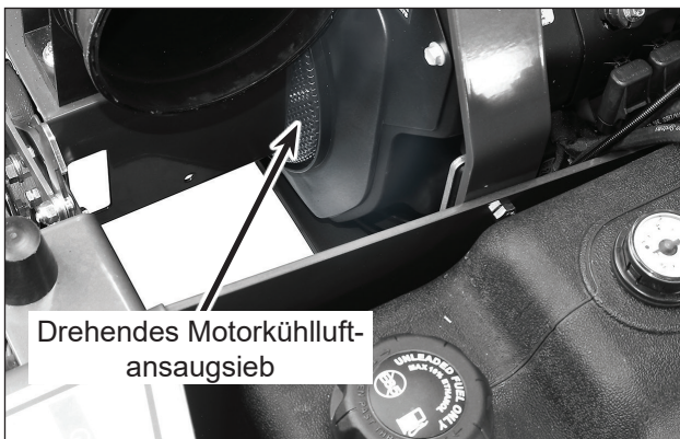
Halten Sie das drehende Motorkühlungs-Lufteinlasssieb sauber
