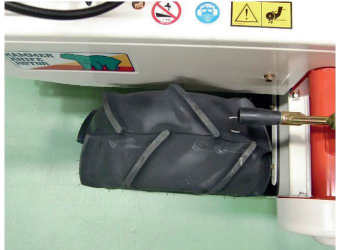
38. Draufsicht auf das rechte Rad. Beachten Sie die Laufrichtung des Rades.
