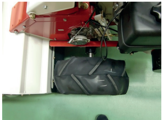
40. Draufsicht auf das linke Rad. Beachten Sie die Laufrichtung des Rades.
