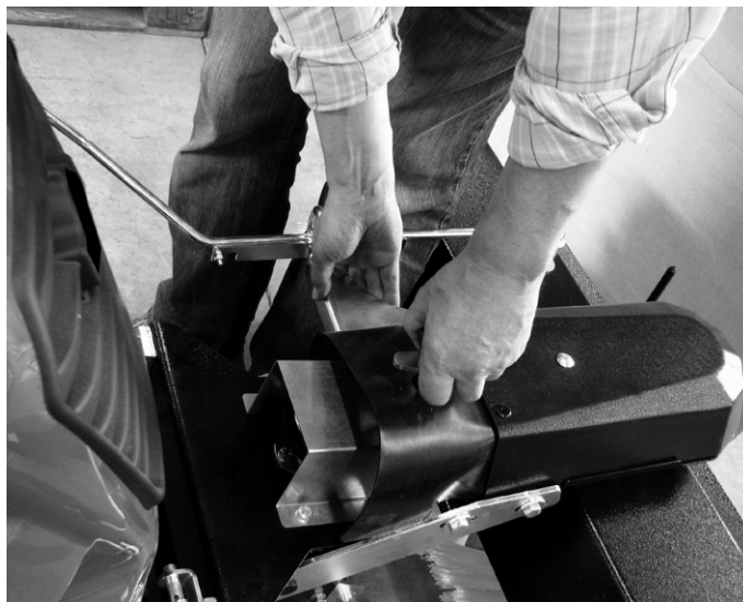
Abbildung 15: Anfasspunkte der Anbau-Kehrmaschine
