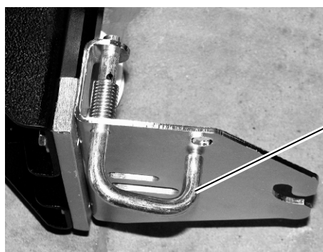
Abbildung 14: Federbügel in offener Position
