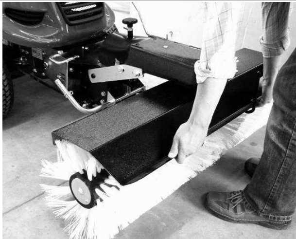
Abbildung 19: Anheben der Anbau-Kehrmaschine
