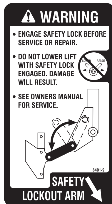
Aufkleber, Sicherheitsverriegelungsarm (Position: Unterer Hubarm)
