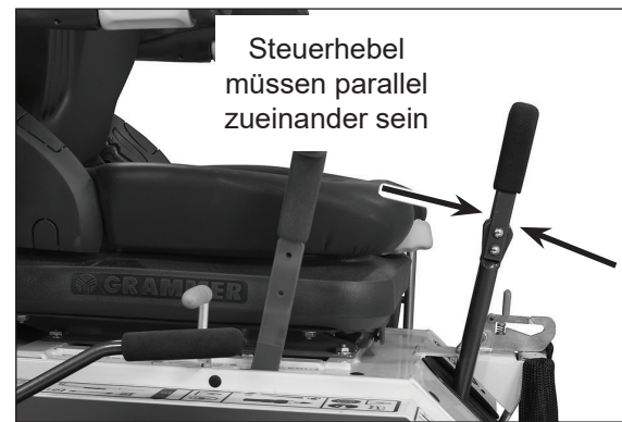
Parallelität der Steuerhebel
