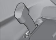
Je stärker das Pedal gedrückt wird, desto schneller wird die Maschine – und umgekehrt.
