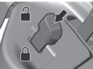
Wenn das Pedal nach unten gedrückt wird, rastet die Sperre ein.
