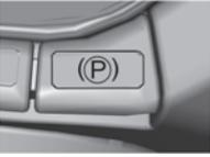
Die Feststellbremse hat zwei Stellungen. In der Stellung **eingedrückt** ist die Bremse nicht aktiviert. Nach dem **Hochziehen** und Treten des Bremspedals wird die Feststellbremse aktiviert (sie bremst).
