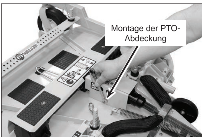
Montage des PTO Schutzes
