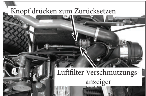
Position des Luftflussanzeigers
