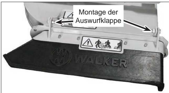
Montage des Auswurfschutzes
