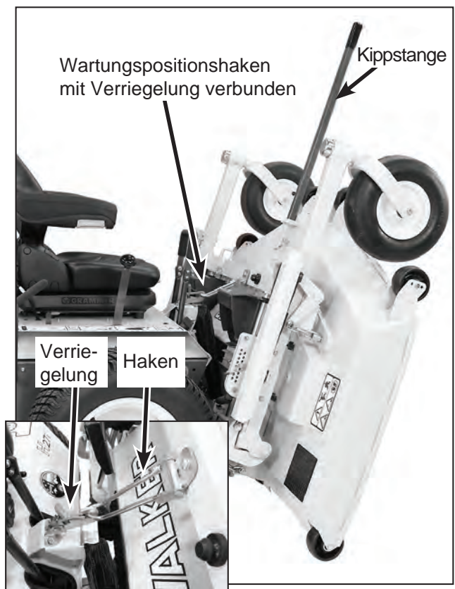
Mähdeck in Wartungsposition gesichert
