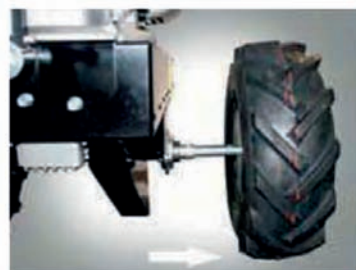
Die linke Achse kann für optimalen Abstand in vier Stufen verstellt werden (25 – 27 – 29 – 31 cm).
