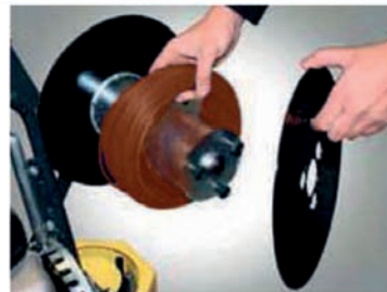
Draht kann einfach aufgespult oder als Ring aufgesteckt werden.
